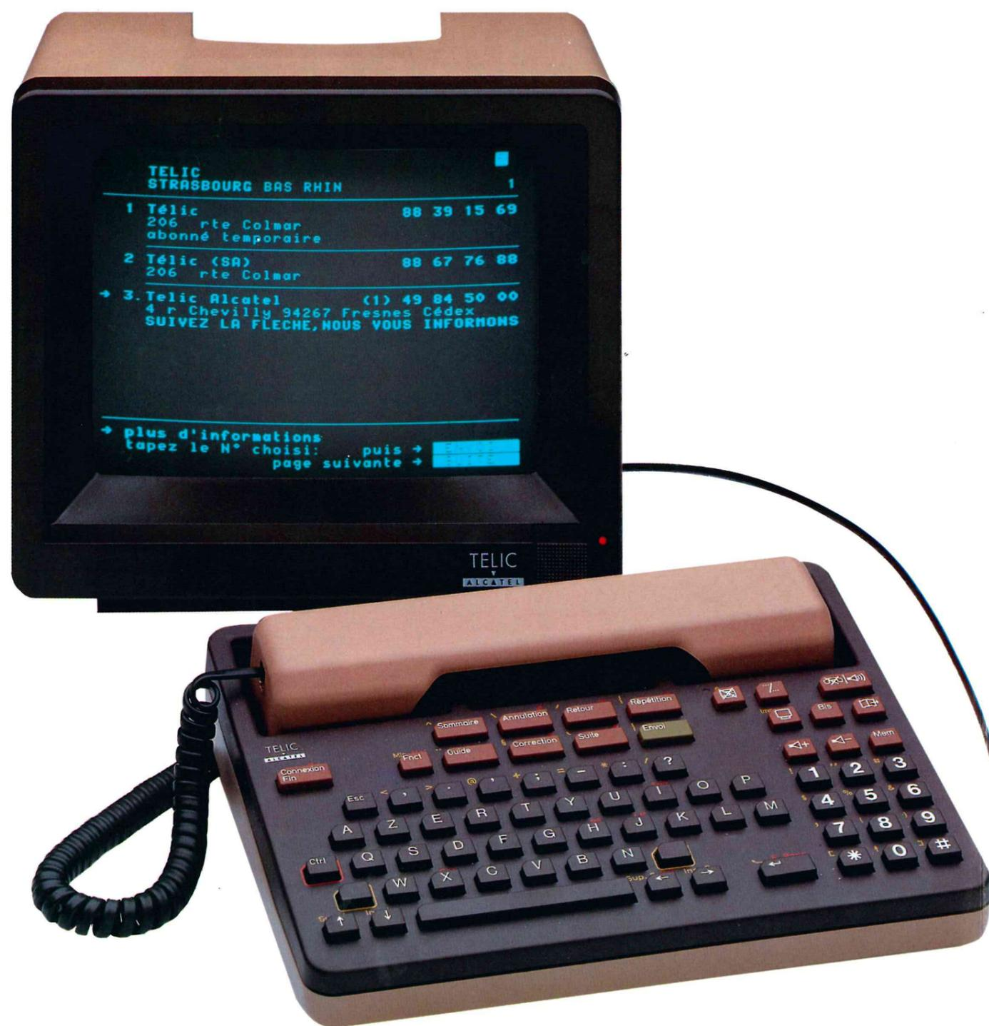
**Le Terminatel 251 rassemble, sous un encombrement minimum, les deux outils de communication les plus utilisés : un terminal vidéotex et un poste téléphonique évolué. Il est doté d'un écran 9 pouces, d'un modem intégré, d'un clavier alphanumérique complet et d'un numéroteur automatique.**
